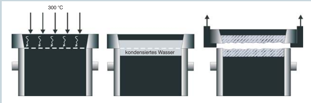
Bild 4: Prinzip der Nasszugfestigkeitsmessung
